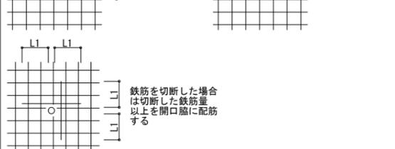
図6-4-2 単独円形小開口の配筋要領 (開口の大きさが床および壁の配筋間隔以下の場合)
