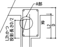
図5-3-2 主筋の外側を通る壁筋の定着方法
